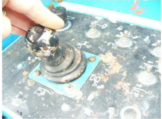
Cuando se haya alcanzado la velocidad de arrastre de la pluma deseada, mueva el interruptor de activación de la transmisión hacia la izquierda o la derecha una vez y suéltelo mientras mantiene la posición de la palanca de mando.
