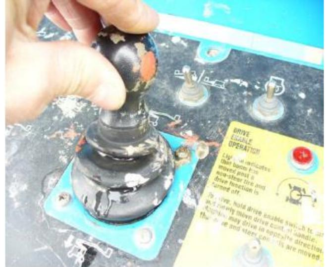
Cuando se haya alcanzado la velocidad de arrastre de la pluma deseada, mueva el interruptor de activación de la transmisión hacia la izquierda o la derecha una vez y suéltelo mientras mantiene la posición de la palanca de mando.
